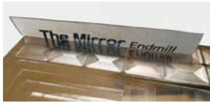
▶ 2h 연속가공 후 Ra(\mu\text{m}) = 0.057
